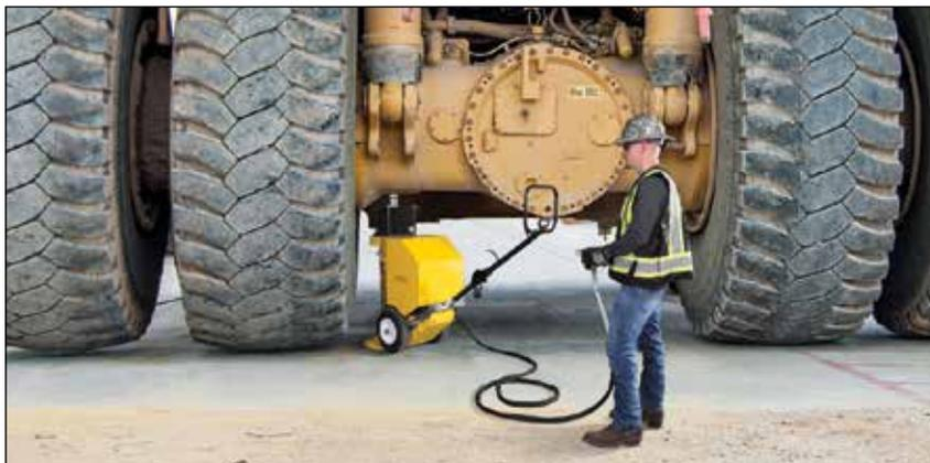
◀ *The PL-Series Pow'R-LOCK Portable Lift System.*
