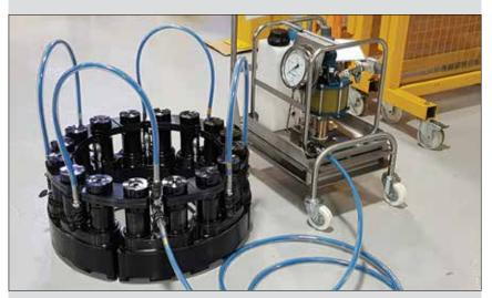
▲ Multi-Stud Tensioning Set-Up.
